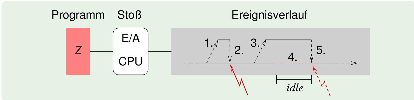
1. Programm Z löst einen zum CPU-Stoß nebenläufigen E/A-Stoß aus
