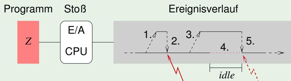
1. Programm Z löst einen zum CPU-Stoß nebenläufigen E/A-Stoß aus
