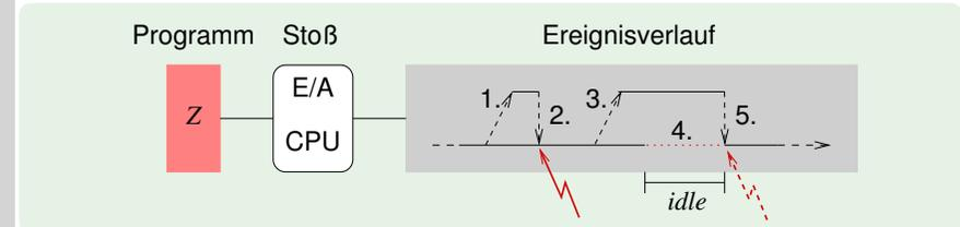
1. Programm Z löst einen zum CPU-Stoß nebenläufigen E/A-Stoß aus
